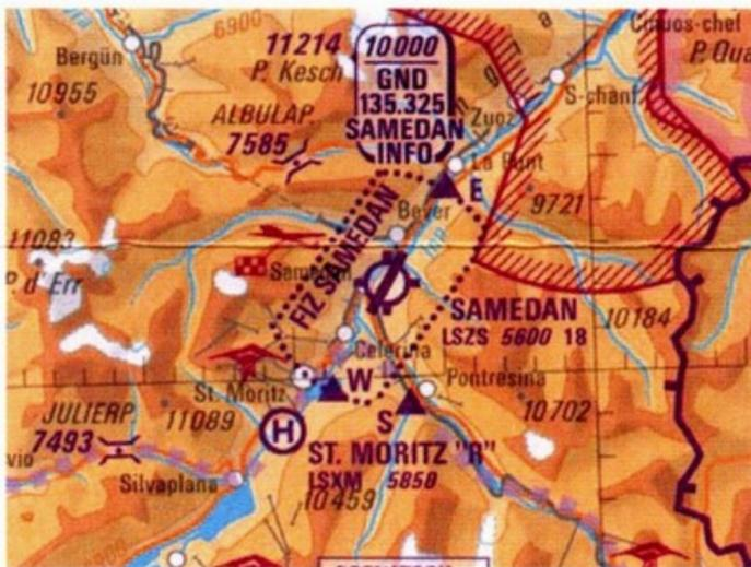
Die FIZ (Flight Information Zone) ist ein Luftraum von bestimmten Abmessungen, in welchem grundsätzlich die Regeln der entsprechenden Luftraum-Klassen gelten, jedoch besteht eine Funkpflicht. Für den Einflug in die FIZ muss **vorgängig** Funkkontakt mit dem betreffenden FISO (Flight Information Service Officer) erstellt sein. Der FISO erteilt keine Freigaben oder Separationen insbesondere keine Start- oder Landefreigaben.
