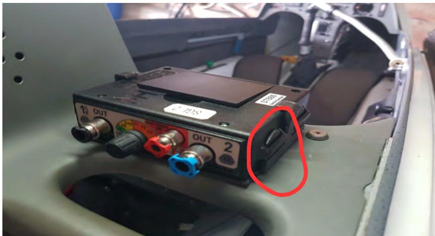
Die Sauerstoffleitung vom Reduzierventil und auch die **Nasenkanüle für den Piloten** unten durch verlegen. Falls die Nasenkanüle oben verlegt wird, dann kann der Capot-Träger die Leitung klemmen.
