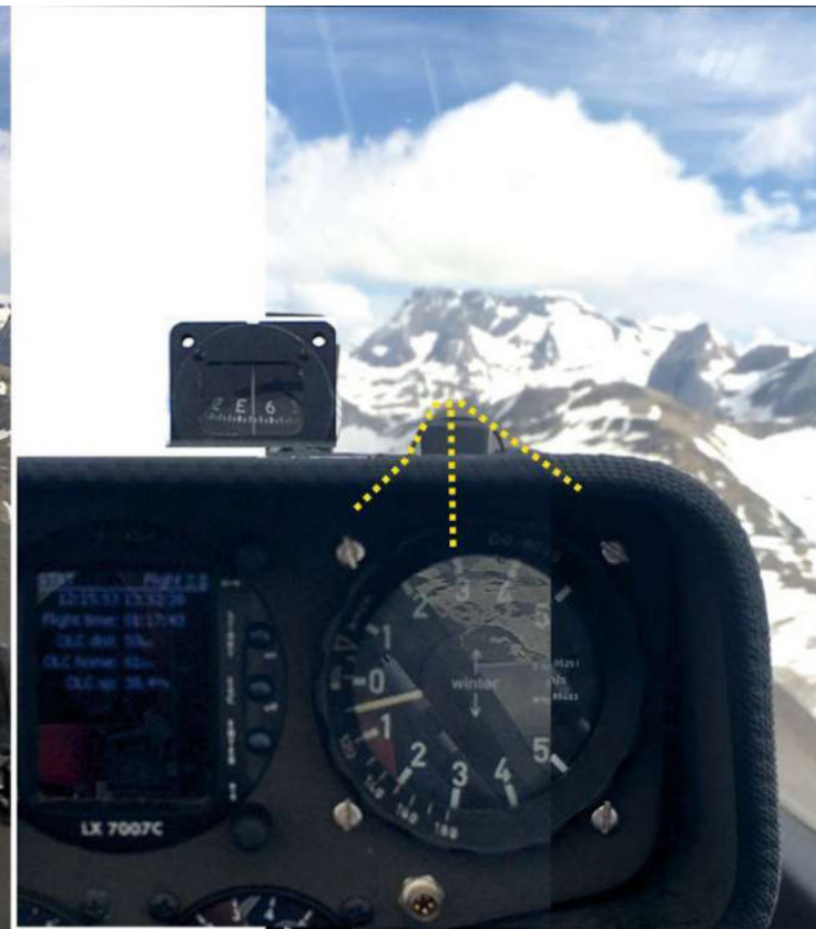
Abbildung 4: Rekonstruktion der Sichtverhältnisse rund 6 Sekunden vor dem Aufprall (vgl. Punkte 2 und 3 in Abbildung 1). Die linke Bildhälfte zeigt das Einzelbild aus der Abbildung 3 ergänzt mit den schematischen Konturen des Mittaghore. Bei dieser Aufnahme befand
