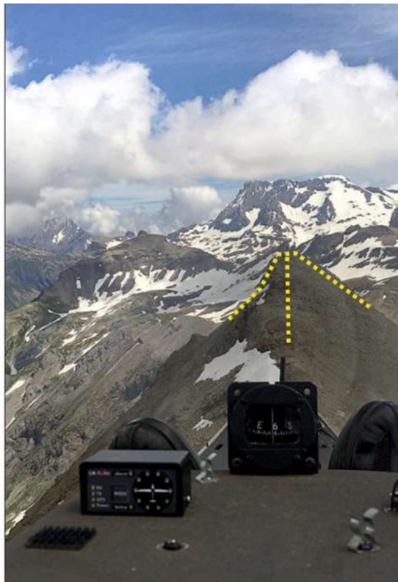
Abbildung 4: Rekonstruktion der Sichtverhältnisse rund 6 Sekunden vor dem Aufprall (vgl. Punkte 2 und 3 in Abbildung 1). Die linke Bildhälfte zeigt das Einzelbild aus der Abbildung 3 ergänzt mit den schematischen Konturen des Mittaghore. Bei dieser Aufnahme befand
